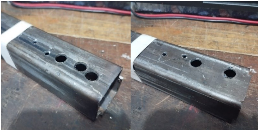
Gambar 4. Hasil pembuatan lubang pada material besi hollow
