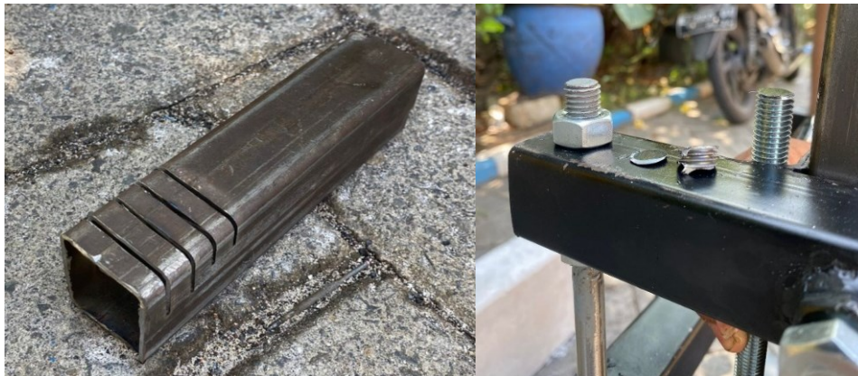
Gambar 5. Hasil pemotongan material besi hollow dan poros ulir
