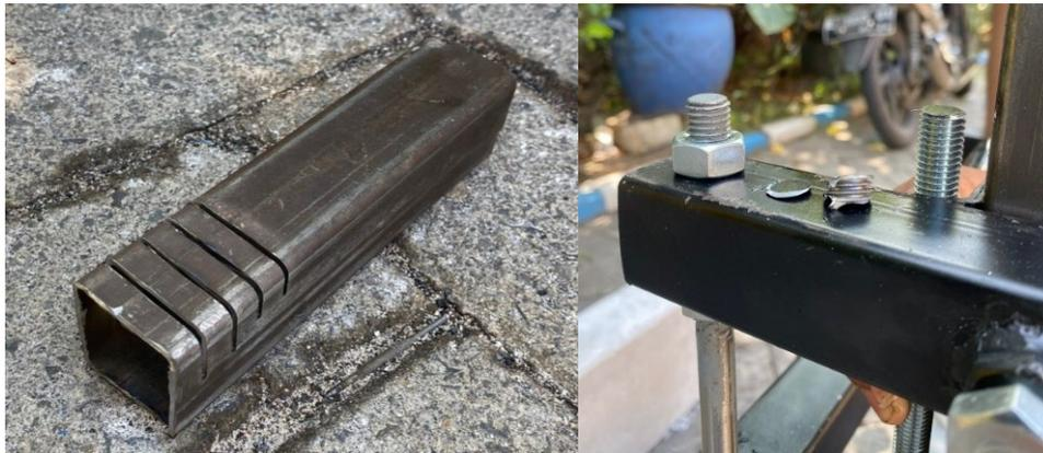
**Gambar 5.** Hasil pemotongan material besi *hollow* dan poros ulir
