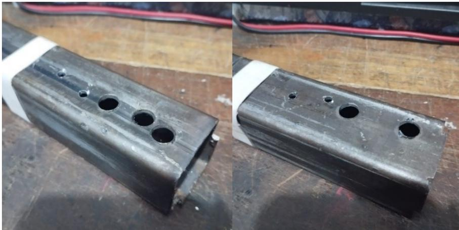
**Gambar 4.** Hasil pembuatan lubang pada material besi hollow
