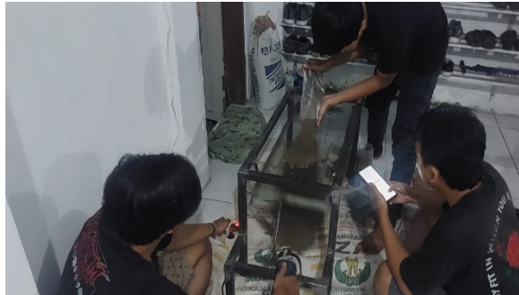
Gambar 4. Pengambilan Data Pengayakan Pasir 1 kg
